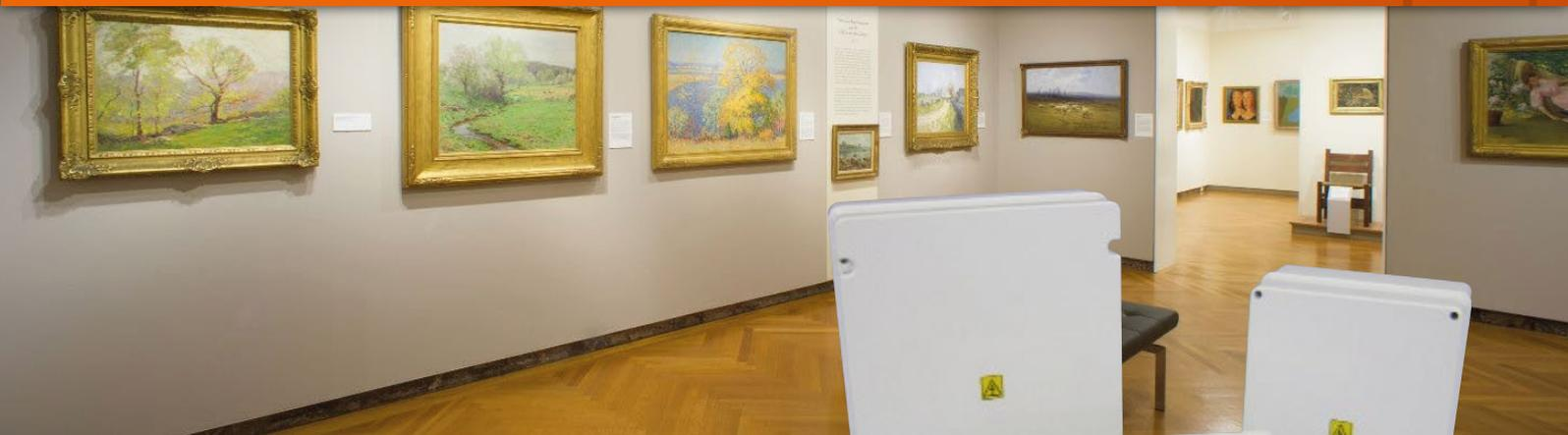
Exclusiva línea de envoltentes para un uso en distribución, empalme, inspección, caja de paso y derivación, contención de relés, temporizador y una amplia gama de comandos. Son fabricados con polímeros de ingeniería de altas cualidades y resistencia a la corrosión, a los rayos UV, a la penetración de polvos y líquidos, como también de autoextinguencia. Cuentan con tapa con un sistema de tornillos imperdibles.
